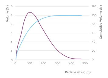
**Laser diffraction** D10: 7 μm D50: 65 μm D90: 190 μm
